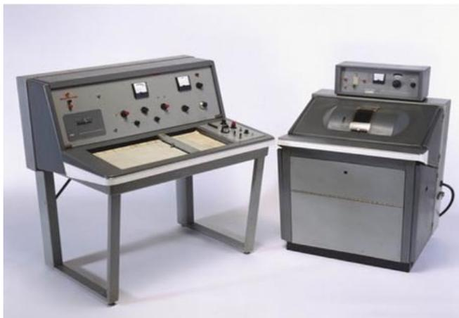
Fig. 2 Lo spettrometro NMR Varian A60, uno dei primi strumenti largamente utilizzati dai chimici per lo studio dei protoni.
