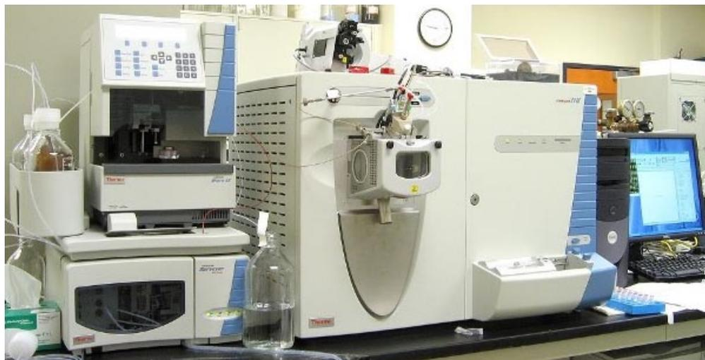
**Fig. 4** Un moderno spettrometro di massa collegato ad uno strumento per cromatografia liquida (LC-MS).
